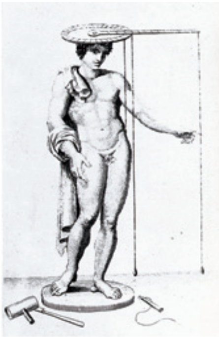
15.3 Rilievo di una statua con l'impiego dello strumento descritto da Leon Battista Alberti nel De statua (da Della Pittura e della Statua , 1804).
